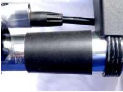
4. Jetzt wird die Halterbasis zusammengefügt. Dazu nimmt man den Schnellverschluss und fügt passend auf der Unterseite die gummierte, leicht angeschrägte Gummihalterung zusammen. Bei einem mit Lenkerband umwickelten Lenker verwendet man das dünne, nicht angeschrägte Teil.
