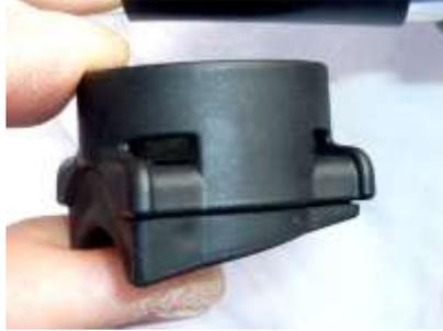
5. In diese Teilekombination werden die Kabelbinder durchgeföhrt (Spitze nach vorne) und dann das Teil auf die Lenkstange an passender Stelle aufsetzt.
