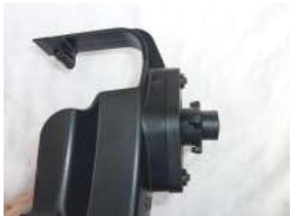
8. Nun kann man das fertige Teil auf die Haltebasis aufstecken. Dazu führt man die vier Haltenoppen über die entsprechenden Öffnungen, drückt dann das ganze Teil vorsichtig aber kräftig nach unten und rastet dann die Halterung mit einer leichten Drehung in die gewünschte Richtung (es handelt sich um etwa 5 mm Drehung!) ein und lässt los. Die Feder im zentralen Befestigungsknopf sorgt dafür, dass die Halterung ein kleines Stück wieder nach oben federt und dann fest sitzt.
