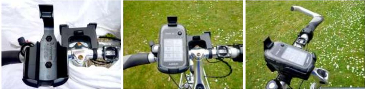
9. Nun kann das „GARMIN eTrex 10/20/30“ mit der unteren Kante zuerst und leichtem Druck auf den oberen Haltehaken in die Halterung eingesetzt werden.
