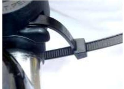
6. Nach geprüfter Position (leichte Schrägstellung Richtung Fahrer/in) werden die beiden Kabelbinder festgezogen und die überflüssigen Enden abgeschnitten.
